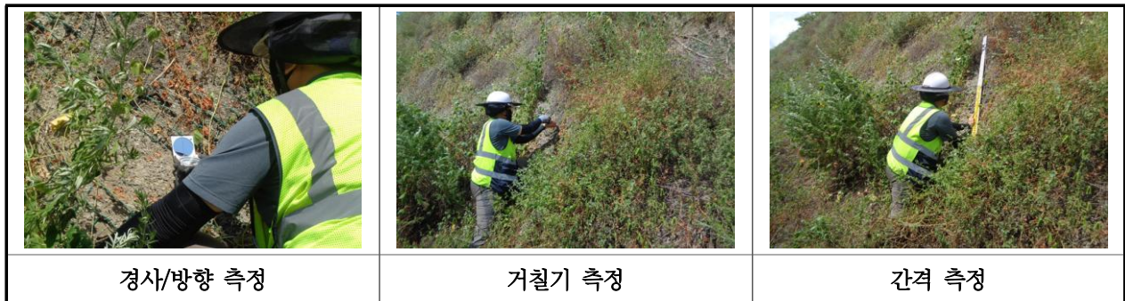
【사진 36.3.3】 불연속면 측정 현황
